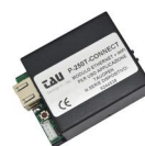
250T-CONNECT Ethernet + WIFI-Gerät, um anhand der App TauOpen die Remote-Verwendung des Smartphones zum Öffnen/Schließen und zur Kontrolle des Zustands des Tors zu ermöglichen
