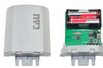
900TWC Wireless Kontaktleisten-Sendereinheit
