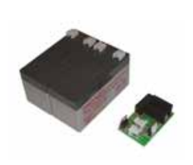
BAT 12K Batteriesatz 24 V (2 x 12 V – 1,2 Ah) mit Ladeplatine
