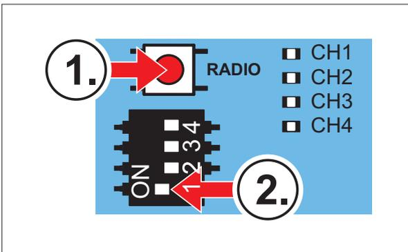
3. Zuerst die RADIO-Taste **drücken und halten**. Währenddessen DIP-Schalter 1 in Position „ON“ bringen.
